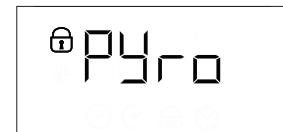
Ko se cikel zaključi, ostanejo vrata zaprta, dokler se temperatura v pečici ne vrne na varno raven. Med uporabo pirolitičnega čiščenja in po njem zračite prostor.
