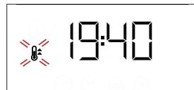
Vă rugăm să rețineți: În timpul procesului de preparare, puteți modifica funcția rotind **butonul de selectare** sau puteți regla temperatura rotind **butonul termostatului**. Funcția nu va porni dacă **butonul termostatului** va fi pe 0. Puteți seta durata de preparare, ora de finalizare a procesului de preparare (numai dacă setați o durată de preparare) și un temporizator.
