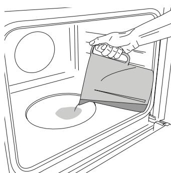
Tek kada je pećnica hladna, napunite udubljenje u pećnici količinom vode navedenom u odgovarajućoj tablici pečenja. Namirnice stavite u pećnicu. Postavite i uključite funkciju **STEAM**: Na kraju pažljivo otvorite vrata i pustite da para polako izade.
