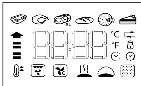
Este visor mostra o relógio, os painéis de controlo para as funções 6<sup>th</sup> Sense (6<sup>th</sup> Sense icon) e Especiais (Special icon), os detalhes de todas as funções e ajuda a regular todos os parâmetros de cozedura.
