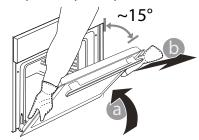
**3.** Ukse tagasi paigaldamiseks asetage see vastu ahju, joondage hingede haagid pesadega ja kinnitage ülemine osa oma pessa.
