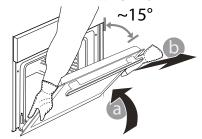
**3.** Įstatydami dureles pastumkite jas link orkaitės, sulygiuokite vyrių kabliukus tvirtinimo vietose ir užfiksuodami viršutinę dalį. Mūvėkite apsaugines pirštines.
