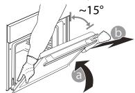
**3.** Dvierka opäť nasadíte tak, že ich priložíte k rúre, zarovnáte háčiky pántov s dosadacími plochami a upevníte vrchnú časť na sedlo. Ak sa nachádza na vnútorných plochách odolná nečistota, na dosiahnutie optimálnych výsledkov čistenia odporúčame spustiť funkciu automatického čistenia.
