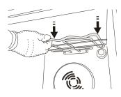
**3.** Aby ponownie umieścić grzałkę na miejscu, należy ją podnieść, lekko pociągnąć do siebie i oprzeć na obsadach bocznych.
