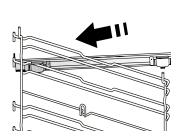
Vyberte vodiace lišty z rúry a z posuvných bežcov odstráňte ochranné plasty. Pripevnite vrchnú svorku bežca na vodiacu lištu a nasuňte, pokiaľ to ide. Druhú svorku spustite na miesto.
