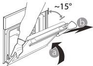
**3.** Założyć drzwiczki, przysuwając je w stronę piekarnika i wyrównując haki zawiasów z miejscami ich zamocowania oraz zablokowując górną część na swoim miejscu.  jeśli występują uporczywe zabrudzenia we wnętrzu piekarnika, zalecamy przeprowadzenie cyklu automatycznego czyszczenia dla uzyskania optymalnych rezultatów czyszczenia.
