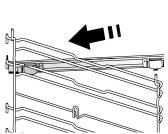
Išimkite lentynų laikiklius iš orkaitės ir nuimkite apsaugines plastikines dalis nuo slankiojančių grotelių. Viršutinį grotelių fiksatorių pritvirtinkite prie skersinių grotelių ir nustumkite jį iki galo. Į tą padėtį nuleiskite ir kitą fiksatorių.
