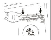
**3.** Para volver a situar la resistencia en su posición, elevarla, tirar de ella ligeramente hacia fuera y comprobar que queda apoyada en las sujeciones laterales.
