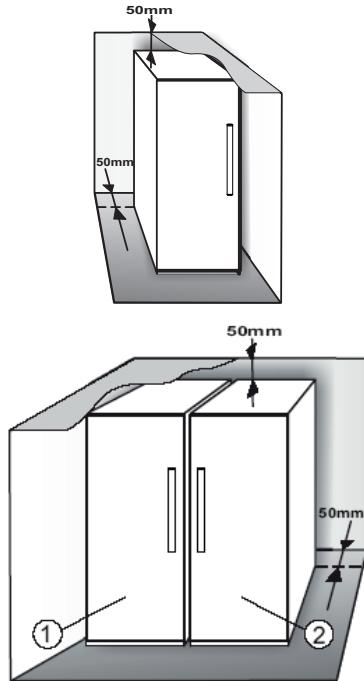
Si consiglia di installare insieme i due apparecchi utilizzando il kit di collegamento ③ (come mostrato in figura).
