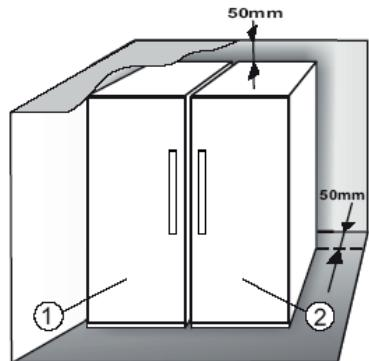
Recomendamos que a instalação dos dois aparelhos em conjunto seja realizada utilizando o kit de ligação ③ (conforme apresentado na figura).
