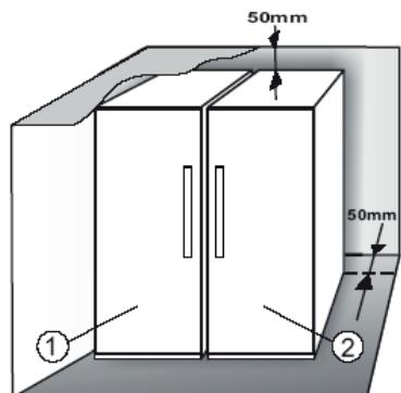
Er wordt aanbevolen twee apparaten samen te installeren met behulp van de verbindingsset ③ (zie de afbeelding). Deze kunt u aanschaffen bij de Consumentenservice.
