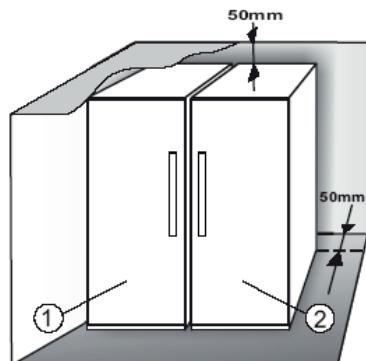
Zalecamy instalowanie dwóch urządzeń przy użyciu zestawu łączącego ③ (jak przedstawiono na rysunku). Można go zakupić w serwisie.
