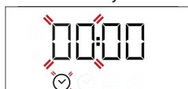
Pomocou + alebo - nastavte hodinu a stlačte ☰ na potvrdenie. Začnú blikat číslice označujúce minúty. Pomocou + alebo - nastavte minúty a stlačte ☰ na potvrdenie.
