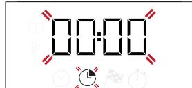
Χρησιμοποιήστε το **+** ή το **-** για να ρυθμίσετε το χρόνο ψησίματος και πατήστε το για επιβεβαίωση.
