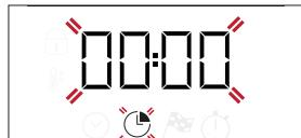
Upotrijebite + ili - za postavljanje potrebnog vremena pečenja i pritisnite za potvrdu. Funkciju uključite okretanjem gumba termostata na potrebnu temperaturu: oglasit će se zvučni signal i na zaslonu će se označiti da je pečenje završeno.
