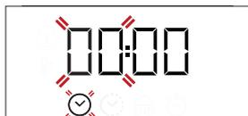
Pro nastavení hodin použijte + nebo - a pro potvrzení stiskněte . Na displeji začnou blikat dvě číslice nastavení minut. Pro nastavení minut použijte + nebo - a pro potvrzení stiskněte .
