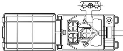
**Η συσκευή πρέπει να συνδεθεί στην τροφοδοσία ρεύματος μέσω ενός πολυπολικού διακόπτη αποσύνδεσης με ελάχιστο διάστημα επαφής 3 mm.**
