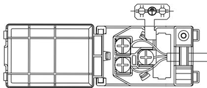
**Forbind apparatet til strømforsyningen ved hjælp af en multipolær afbryder med en kontaktafstand på mindst 3 mm.**
