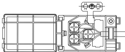
**Spotrebič musí byť pripojený k zdroju napájania prostredníctvom viacpólového spínača s minimálnou vzdialenosťou medzi kontaktmi 3 mm.**
