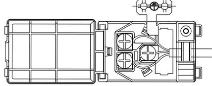
**Spotřebič musí být ke zdroji el. napájení připojen pomocí všepólového odpojovacího zařízení s minimální vzdáleností mezi kontakty 3 mm.**
