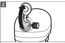
Coloque a tampa da estrutura de fixação articulada para cima para abrir.
