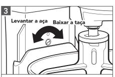
Ajuste de modo a que o batedor plano não toque no fundo da taça quando estiver na posição levantada, rodando o parafuso para a esquerda para levantar a taça e para a direita para baixar a taça. Apenas uma ligeira volta é tudo o que é necessário: o parafuso (A) não roda mais de 1/4 de volta (90 graus) em qualquer direção. (O intervalo completo de ajuste é de 1/2 de volta ou 180 graus.)
