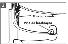
Para fixar a taça: coloque a alavanca de elevação da taça na posição para baixo. Encaixe os suportes da taça nos pinos de localização. Pressione a parte traseira da taça até que o pino da taça se encaixe no trinco de mola.
