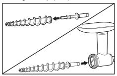
Posizionare il cono del passaverdure sull'ingranaggio a vite lungo facendo corrispondere l'incavo del cono del passaverdure con la linguetta sulla parte inferiore del corpo principale.
