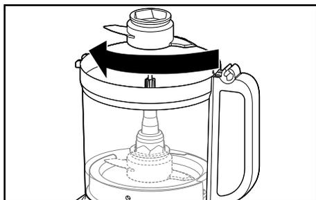
2. Instale a tampa da taça e certifique-se de que o trinco da tampa é empurrado para baixo, para a posição de bloqueio.
