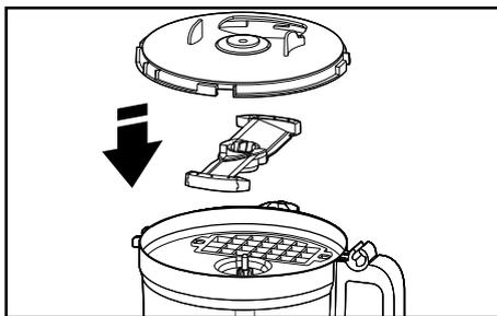
2. Alinhe a tampa do kit de corte em cubos com a abertura de alimentação ampla.
