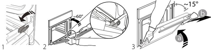
Покладіть зняті дверцята на м'яку поверхню. Щоб встановити дверцята на місце, піднесіть їх до духової шафи, вирівняйте гачки петель з їхніми пазами та закріпіть верхню частину у пазі. Опустіть дверцята, а потім повністю відчиніть їх. Опустіть засувки в початкове положення: Переконайтеся, що вони повністю опущені. Спробуйте зачинити дверцята й перевірте, чи перебувають вони на одній лінії з панеллю керування. Якщо це не так, знову виконайте описані вище кроки.
