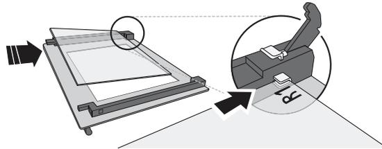
Remplacez le bord supérieur : un déclic indique le positionnement correct. Assurez-vous que le joint est bien placé avant de replacer la porte.
