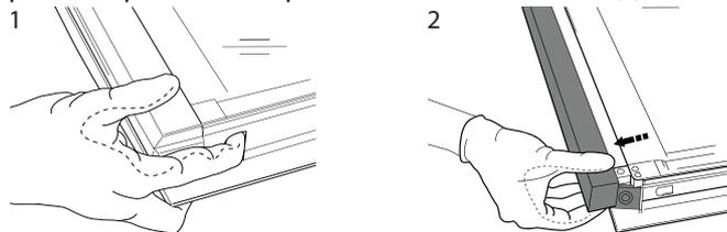
Sollevarlo e afferrare saldamente il vetro interno con due mani, rimuoverlo e appoggiarlo su un piano morbido prima di eseguire la pulizia (3).
