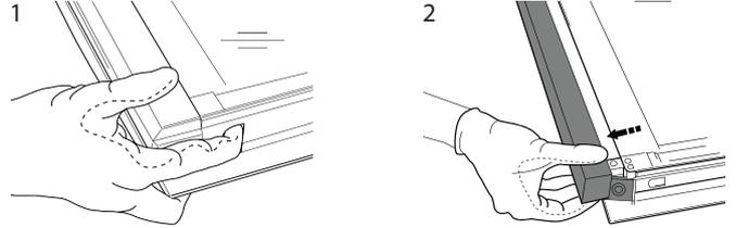
Levante e segure firmemente o vidro interior com ambas as mãos, removendo-o e colocando-o sobre uma superfície suave antes de proceder à sua limpeza (3).
