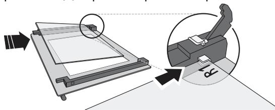
Rimontare il profilo superiore: un clic indica il corretto posizionamento. Verificare che la tenuta sia salda prima di rimontare la porta.
