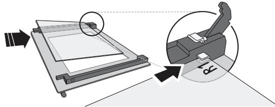
Instale novamente a extremidade superior: irá ouvir um clique, indicando que está bem posicionado. Certifique-se de que a vedação está segura antes de montar novamente a porta.
