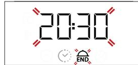
Utilice **+** o **-** para ajustar el tiempo deseado de finalización de la cocción y pulse
