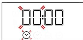
Utilice + o - para ajustar la hora y pulse ☹ para confirmar. Los dos dígitos de los minutos empezarán a parpadear. Utilice + o - para ajustar los minutos y pulse ☹ para confirmar.
