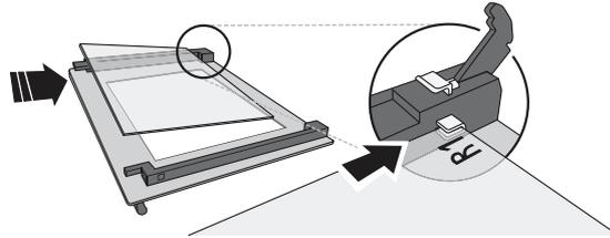
Vuelva a colocar la parte superior: un clic le indicará que se ha colocado correctamente. Asegúrese de que el precinto esté asegurado antes de volver a montar la puerta.
