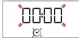
Utilice **+** o **-** para configurar el tiempo de cocción deseado y después pulse
