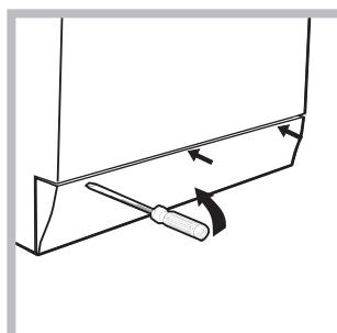
1. Nehmen Sie die Abdeckung (befindlich an der Gerätetür) mit Hilfe eines Schraubenziehers ab (siehe Abbildung);
