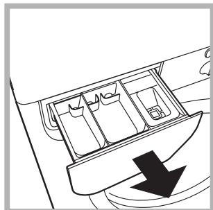
Vytáhněte dávkovač jeho nadzvednutím a vytážením směrem ven (viz obrázek). Umyjte jej pod proudem vody; tento druh vyčištění je třeba provádět pravidelně.
