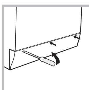
1. verwijder het afdekpaneel aan de voorkant van de wasautomaat met behulp van een schroevendraaier (*zie afbeelding*);
