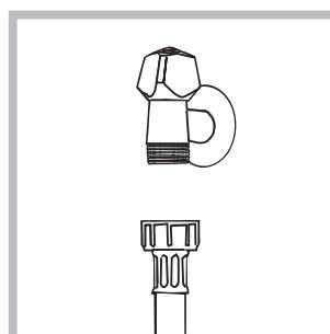
1. Sluit de toevoerbuis aan op de koudwaterkraan met een mondstuk met Schroefdraad van 3/4 gas (*zie afbeelding*).
