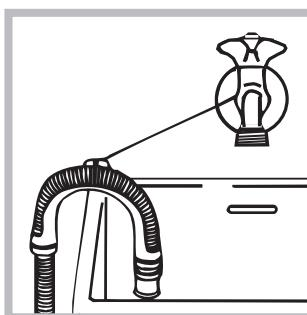
nebo ji uchytíte k okraji umývadla či vany a připevněte vodicí držák z příslušenství ke kohoutu (viz obrázek). Volný konec vypouštěcí hadice nesmí zůstat ponořený do vody.
