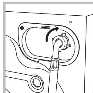
2. Das andere Ende des Schlaubes an den oben rechts am Rückteil des Waschvollautomaten befindlichen Wasseranschluss anschließen (siehe Abbildung).
