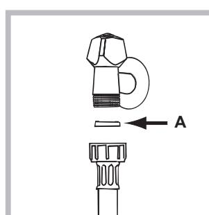
1. Підключити живлячий трубопровід, прикрутивши його до крану холодної води за допомогою штуцера з газовою різьбою 3/4 (див. малюнок). Перед підключенням спустіть воду, доки вона не стане прозорою.
