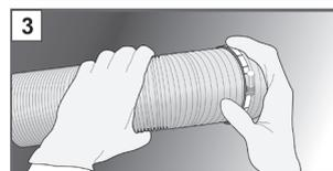
Coloque una de las abrazaderas en el extremo de la manguera de ventilación alargada. Se puede utilizar otra abrazadera para fijar el extremo opuesto de la manguera de ventilación a un kit de montaje en la pared (kit y abrazadera no incluidos).
