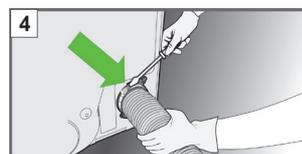
Sujete con una abrazadera la manguera de ventilación a la salida de ventilación trasera apretando la abrazadera con un destornillador. Si no se ha alargado la manguera, la abrazadera no podrá sujetar la manguera a la salida de ventilación trasera.
