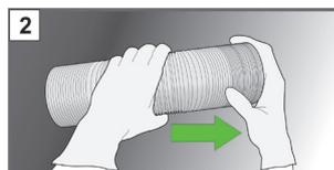
Tire del extremo de la manguera de ventilación para alargarla antes de colocarla. Si no se ha alargado la manguera, la abrazadera no podrá sujetarla al adaptador.
