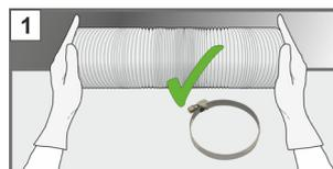
Saque la manguera de ventilación del embalaje. Asegúrese de retirar también la abrazadera. Si necesita reducir la longitud de la manguera, utilice guantes para cortarla.
