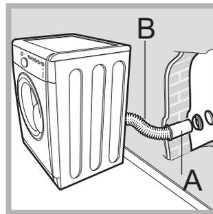
El orificio debe estar lo más abajo posible y el tubo debe ser lo más corto posible. Dependiendo de la frecuencia de uso de la secadora, es fundamental revisar periódicamente las zonas A y B para eliminar pelusas o residuos. Asegúrese de que la manguera de ventilación, las rejillas de entrada de aire y las salidas no estén obstruidas o bloqueadas. El
