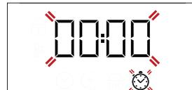
Utilizați + sau - pentru a seta ora și apăsați pe pentru a confirma. Se va emite un semnal sonor odată ce temporizatorul a finalizat numărătoarea inversă a duratei de timp selectate.
