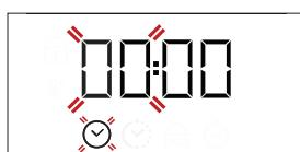
Saatı ayarlamak için + veya -'ı kullanın ve onaylamak için 'e basın. Dakikaya ait iki rakam yanıp sönmeye başlayacaktır. Dakikayı ayarlamak için + veya -'ı kullanın ve onaylamak için 'e basın.
