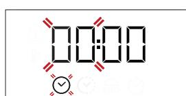
Pro nastavení hodin použijte + nebo — a pro potvrzení stiskněte ○. Na displeji začnou blikat dvě číslice nastavení minut. Pro nastavení minut použijte + nebo — a pro potvrzení stiskněte ○.
