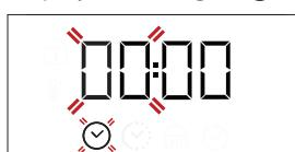
Izmantojiet + vai —, lai iestatītu stundas, un nospiediet ○, lai apstiprinātu. Displejā mirgos divi cipari, kas apzīmē minūtes. Izmantojiet + vai —, lai iestatītu minūtes, un nospiediet ○, lai apstiprinātu.
