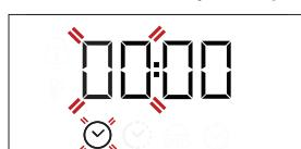
Uporabite + ali — za nastavitev ure in pritisnite ☰ za potrditev. Števki za minute začneta utripati. Uporabite + ali — za nastavitev minut in pritisnite ☰ za potrditev.
