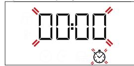
Gebruik **+** of **-** om de tijd te regelen en druk op **⌚** om te bevestigen.
