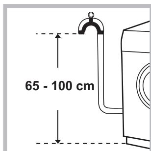
Collegare il tubo di scarico, senza piegarlo, a una conduttrice di scarico o a uno scarico a muro posti tra 65 e 100 cm da terra;
