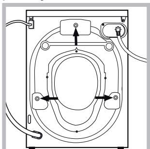
3. Odstraňte 3 šrouby chránící před poškozením během přepravy a gumovou podložku s příslušnou rozpěrkou, které se nacházejí v zadní části (viz obrázek).
