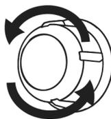
3. Se a lâmpada do forno for do tipo (A) mostrado na figura abaixo, rodar a lâmpada do forno conforme mostrado na figura e substituir a mesma por outra nova. Se for um modelo do tipo (B), puxar a mesma para fora como mostrado na figura e substituí-la por uma outra nova.
