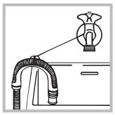
Otra alternativa es apoyar el tubo de desagüe en el borde de un lavamanos o de una bañera, uniendo la guía (puesta a disposición para la venta por el servicio de asistencia) al grifo (ver la figura). El extremo libre del tubo
