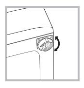
2. Si el piso no está perfectamente horizontal, compense las irregularidades desenroscando o enroscando las patas delanteras (ver la figura); el ángulo de inclinación medido sobre la superficie de trabajo, no debe superar los 2°.
