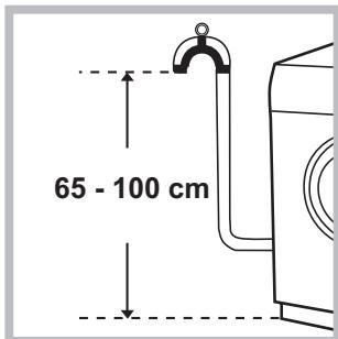
Tilkople tømmeslangen, uten å bøye den, for å tømme et rør eller veggavløp som befinner seg i en høyde på mellom 65 og 100 cm fra gulvet,
