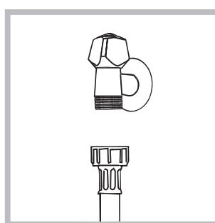
1. Anslut inloppsslagens ände och skruva fast den på en kalvattenkran som har en öppning med 3/4 gasgånga (se figur). Innan du ansluter slangen ska du låta vattnet rinna tills det är helt klart.
