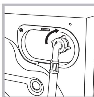
2. Anslut inloppsslangen till Tvätt- och torkmaskinen genom att skruva fast den till det avsedda vattenuttaget i den bakre delen upp till höger (se figur).
