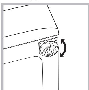
2. Hvis gulvet ikke er helt flatt, skal denne ujevnheten kompenseres for ved å trekke til eller løsne de justerbare frontføttene (se figur); hellingsvinkelen målt i forhold til arbeidsbenken skal ikke overstige 2°.
