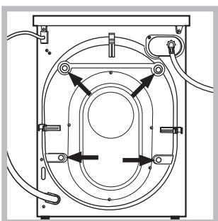
3. Poista 4 kuljetuksen suojaruuvia sekä tiiviste vastaavan välikappaleen kanssa, jotka sijaitsevat takaoissa (katso kuva).
