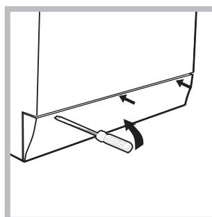
1. Ta bort skyddspanelen på tvätt- och torkmaskinens framsida med hjälp av en skravmejsel (se figur).
