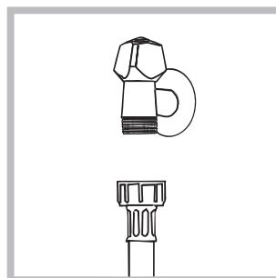
1. Fastgør forsyningsslangen ved at skru den fast til en koldt-vandshane med det gevindskårne 3/4 mundstykke (se figuren). Inden tilslutningen skal vandet løbe, indtil det er klart.
