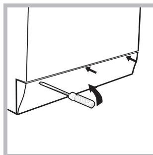
1. Fjern tildækningspanelet på forsiden af vaske/tørremaskinen ved hjælp af en skruetrækker (se illustrationen).
