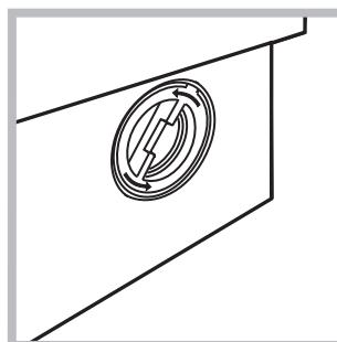
2. Lossa locket genom att vrinda det moturs (se figur): Det är normalt att lite vatten rinner ut.
