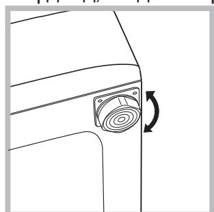
2. Ако подът не е идеално хоризонтален, компенсирайте неравностите, като отвиете или завиете предните крачета (виж фигурата); ъгълът на наклона, измерен върху работната повърхност, не трябва да надвишава 2°.
