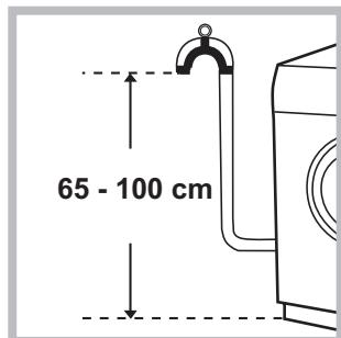
Tilslut afløbsslangen, uden at den bøjes, til et afløbsrør eller et vægmonteret afløb anbragt mellem 65 og 100 cm over jorden,
