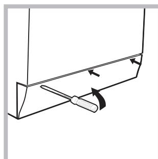
1. Ved bruk av en skrutrekker, fjernes panelet på nederste forside av vaskemaskinen-tørketrommelen (se figur);
