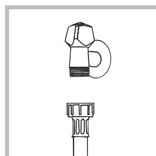
1. Kople inntaksslangen ved å skru den til en kaldtvannskran med gjengetut  $\frac{3}{4}$  gass (se figur). Før tilkoplingen, la vannet renne helt til det renner rent vann.
