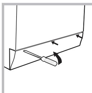
1. свалете панела в предната част на пералната машина с помощта на отвертка (вж. фигура);
