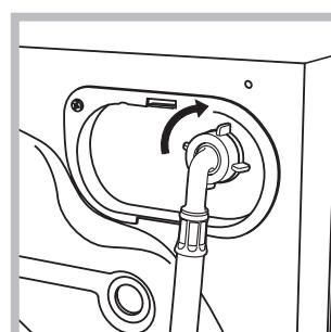
2. Tilkople inntaksslangen til Vaskemaskinen-tørketrommelenen ved å skru den på tilhørende vanninnatak på apparatet, som befinner seg øverst til høyre på apparatets bakside (se figur).
