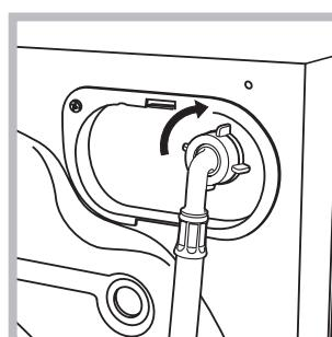
2. Skru forsyningsslangen til Vaske/Tørremaskinen på vandindtaget øverst til højre bagpå (se illustrationen).
