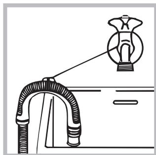
tai aseta se pesualtaan tai kylpyammeen laidalle kiinnittääne toimitettu ohjain hanaan (*katso kuva*). Poistoletkun vapaan pään ei tule jäädä upoksiin veteen.
