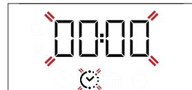
Utilize + ou — para definir o tempo de cozedura pretendido e, em seguida, prima para confirmar. Ative a função rodando o botão do termóstato para a temperatura requerida: é emitido um sinal sonoro e o visor indica que a cozedura está concluída.
