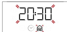
Utilice + o — para ajustar el tiempo deseado de finalización de cocción y pulse para confirmar. Active la función girando el *selector del termostato* hasta la temperatura deseada: la función se iniciará automáticamente cuando haya transcurrido el periodo de tiempo calculado para que la cocción termine a la hora programada.
