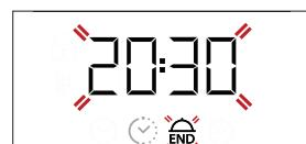
Utilize + ou — para definir o tempo de fim da cozedura pretendido e, em seguida, prima para confirmar. Ative a função rodando o botão do termóstato para a temperatura requerida: a função irá permanecer em pausa até ser iniciada automaticamente após o período de tempo calculado para concluir a cozedura à hora programada.
