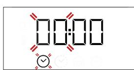
Tundide seadmiseks vajutage nuppu + või — ja kinnitamiseks vajutage nuppu ☰. Hakkab vilkuma kahekohaline minutite näidik. Minutite seadmiseks vajutage + või — ja kinnitamiseks vajutage ☰.
