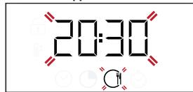
Пісіру аяқталуы тиіс уақытты орнату үшін + немесе — түймелерін пайдаланыңыз және растау үшін түймесін басыңыз. Функцияны *термостат тетігін* қажетті температураға бұрау арқылы іске қосыңыз: функция орнатылған уақытқа сәйкес пісіру үшін есептелген уақыттан кейін автоматты тұрдеге қосылмағанша кідіртілген күйінде қалады.
