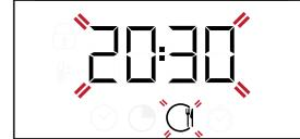
За допомогою кнопки або — встановіть бажаний час завершення готування і натисніть для підтвердження. Активуйте функцію, встановивши ручку терmostата на бажану температуру: Функцію буде призупинено до її автоматичного запуску після періоду часу, який розраховано так, щоб закінчити приготування у встановлений час.
