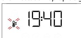
Om de functie te onderbreken, zet de oven uit, draai de *keuzeknop* en de *thermostaatknop* op **O** en ●.
