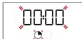
+ oder — zum Einstellen der gewünschten Garzeit verwenden, anschließend
