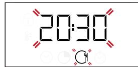
oder + verwenden — zum Einstellen der Abschaltzeit und
