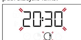
Izmantojiet + vai -, lai iestatītu vēlamo gatavošanas beigu laiku, un nospiediet , lai apstiprinātu. Lai palaistu atlasi funkciju, pagrieziet *termostata slēdzi* līdz vēlamai temperatūrai: funkcija tiks apturēta, taču tiklīdz būs pagājis laiks, kas aprēķināts, lai gatavošana beigtos jūsu noteiktajā laikā, funkcija sāks automātiski darboties.
