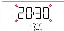
Даярдоонун аякташын талап кылган убакытты тандоо үчүн + же — көлдөнүз жана ⏳ басып ырастыңыз. **Термостат бурагычын** талап кылган температурага буроо менен функцияны иштетиңиз: функция тыныгуда болуп турат жана сиз жөнгө салган убакытта даярдоону аяктаууга белгиленген убакыттан кийин меш автоматтык түрдө иштеп баштайт.
