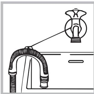
Befestigen Sie diesen mittels des mitgelieferten Schlauchhalters z.B. an einen Wasserhahn (siehe Abbildung). Das freie Ablaufschlauchende darf nicht unter Wasser positioniert werden.
