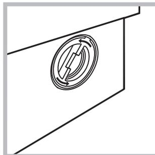
2. draai het deksel eraf, tegen de klok in (zie afbeelding): het is normaal dat er een beetje water uit komt;
