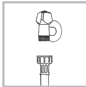
1. Schrauben Sie den Wasserschlauch an einen Kaltwasserhahn mit 3/4-GAS-Gewindeanschluss an (siehe Abb.). Lassen Sie das Wasser vor dem Anschluss so lange auslaufen, bis klares Wasser austritt.
