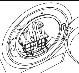
Retirar el filtro de la puerta y colocar el soporte. Los cordones deben introducirse en el interior de las zapatillas: las puntas deben dirigirse hacia abajo y las suelas hacia el frente. No añadir otra ropa u otras zapatillas dentro del cesto. Volver a colocar el filtro de la puerta después del secado.
