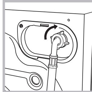
2. Raccorder le tuyau d'arrivée de l'eau au lave-linge en le visant à la prise d'eau prévue, dans la partie arrière en haut à droite (*voir figure*).
