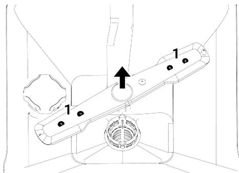
Compruebe si los orificios del conjunto del brazo rociador están bloqueados. Si hay una obstrucción, retire y limpie el conjunto del brazo rociador. (depende del modelo)
