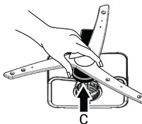
Para desmontar y limpiar el conjunto del brazo rociador inferior, retírelo agarrando los puntos (C) que se muestran en la figura con una mano y tirando hacia arriba. Después de limpiarlo, vuelva a instalar el conjunto del brazo rociador siguiendo el mismo procedimiento en orden inverso.
