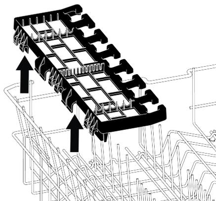
Podrá volver a colocar el soporte de servicio multifunción de la cesta superior en el lateral de ésta fácilmente para volver a utilizarlo.
