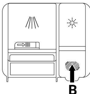
4. Aumente el ajuste si aparecen marcas de agua en la vajilla después del lavado, o disminúyalo si queda una marca azul al limpiarla con la mano. Este ajuste viene ajustado de fábrica en la posición 3.
