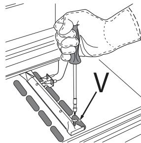
5. Відгиніть сопло пальника спеціальним торцевим ключем для пальників, або, ще краще, торцевим ключем 7 мм, і замініть соплом, придатним до роботи з новим типом газу (див. таблицю 1).
