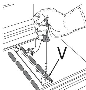
5. Вывинтите жиклер горелки при помощи специального торцевого ключа для жиклеров, или, что предпочтительнее, торцевым ключом на 7 мм, и замените его жиклером, пригодным для нового типа газа (см. Таблицу 1).
