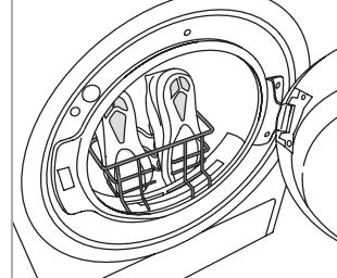
Retire o filtro da porta e coloque o suporte. Os atacadores devem ser enfiados dentro do sapato: a ponta do sapato deve ficar para baixo e as solas para frente. **Não coloque roupa ou outros sapatos no tambor.** Reponha o filtro da porta no fim da secagem.
