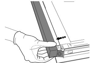
**2.** Z obema rokama dvignite in čvrsto držite notranje steklo, ga odstranite in položite na mehko površino, preden ga očistite.
