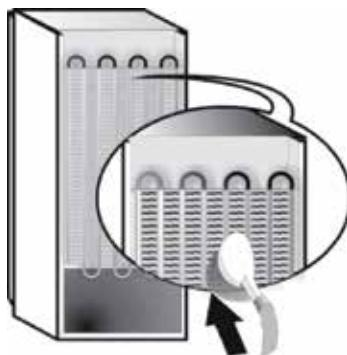
For å sikre at smeltevannet kan strømme uavbrutt og korrekt, rengjør innsiden av avløpshullet bak på kjøleskapet i nærheten av frukt- og grønnsakkskuffen regelmessig, med vedlagt redskap.
