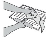
6. Włożyć tackę z powrotem, umieszczając tylną część w zagłębieniach pokazanych na rysunku, a następnie przymocować uchwyt w zapięciach powyżej.
