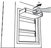
2. Odvojite dodatak STOP FROST i uklonite ga, vodeći računa da ga ne isпустite na staklenu policu ispod.
