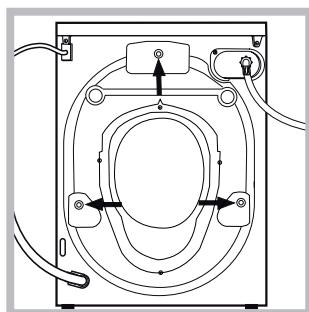
3. Scoateți cele 3 șuruburi de protecție pentru transport și cauciucul cu respectivul distanțier, situate în partea posterioară (a se vedea figura).
