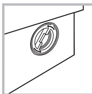
2. dévisser le couvercle en le tournant dans le sens inverse des aiguilles d'une montre (voir figure): il est normal qu'un peu d'eau s'écoule;
