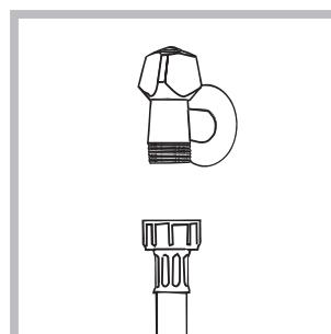
1. A vízbevezető cső csatlakoztatásához csavarozza fel a csövet egy 3/4"-os külső menettel rendelkező hidegvíz csapra (lásd ábra). A csatlakoztatás előtt eressze meg a csapot addig, amíg a víz teljesen átlátszóvá nem válik.
