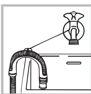
Oder hängen Sie den Ablaufschlauch in ein Becken oder eine Wanne ein; befestigen Sie ihn in diesem Falle mittels der Führung (beim Kundendienst erhältlich) an dem Wasserhahn (siehe Abbildung). Das freie Ablaufschlauchende darf nicht unter Wasser positioniert werden.
