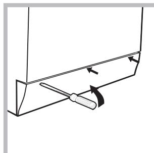
1. démonter le panneau avant à l'aide d'un tournevis (voir figure);
