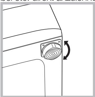
2. Sollte der Boden nicht perfekt eben sein, müssen die Unebenheiten durch An- bzw. Ausdrehen der vorderen Stellfüße ausgeglichen werden (siehe Abbildung), der auf der Arbeitsfläche zu ermittelnde Neigungsgrad darf  $2^\circ$
