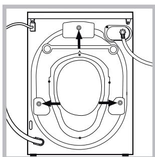
3. Csavarozza ki a készülék hátsó részén található, a szállításhoz szükséges 3 védőcsavart, és távolítsa el a gumibakot a távtartójával együtt (lásd ábra).
