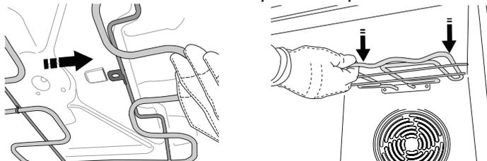
**2. Para voltar a colocar a resistência** na sua posição original, levante-a, puxe-a ligeiramente para si e certifique-se de que o suporte está na posição correta.
