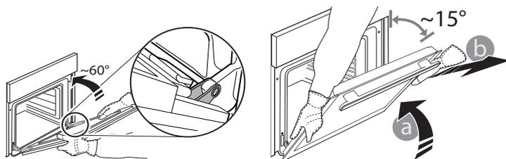
**3.** Dvířka opět nasadíte tak, že je přiložíte k troubě, nasměrujete háčky pantů oproti jejich usazení a do příslušného usazení zajistíte i horní část.
