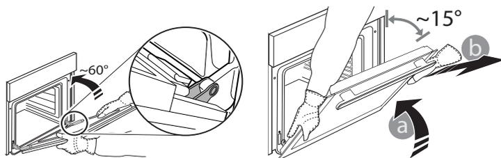
**3. Reponha a porta**, deslocando-a na direção do forno e alinhando os ganchos das dobradiças com os respetivos suportes, fixando a parte superior aos suportes.
