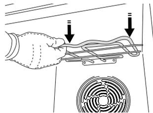
**2.** Para volver a colocar la resistencia en su posición, levántela y tire con cuidado hacia usted para asegurarse de que el soporte de la lengüeta esté en su alojamiento.
