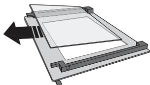
3. Przed umieszczeniem szyby wewnętrznej z powrotem na miejscu należy najpierw zamontować szybę środkową (zaznaczoną „1R”): Aby właściwie umieścić szyby, należy upewnić się, że znak „R” jest widoczny w lewym rogu. W pierwszej kolejności należy umieścić dłuższą część szyby oznaczoną literą „R” w odpowiednich uchwytach, a następnie obniżyć ją do właściwej pozycji. Powtórzyć tę procedurę dla obu szyb.
