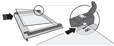
4. Vuelva a colocar la parte superior: un clic le indicará que se ha colocado correctamente. Asegúrese de que el precinto esté asegurado antes de volver a montar la puerta.
