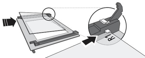
4. Zamontować ponownie górną krawędź: Charakterystyczne kliknięcie sygnalizuje prawidłową pozycję. Przed ponownym założeniem drzwiczek należy upewnić się, że uszczelka nie zostanie uszkodzona.
