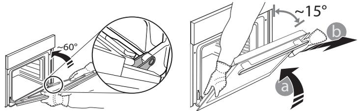
**3.** Vuelva a instalar la puerta llevándola hacia el horno, alineando los ganchos de las bisagras con sus alojamientos y fijando la parte superior en su alojamiento.
