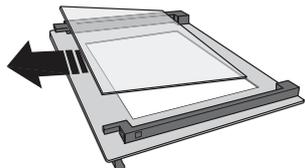
3. Instale novamente o painel (com a marca "1R") antes de instalar o painel interior: Para posicionar os painéis de vidro corretamente, certifique-se de que é possível visualizar a marca "R" no canto esquerdo. Insira primeiro a parte mais longa do vidro com a indicação "R" nos suportes e, em seguida, baixe-a até à posição correta. Repita este procedimento para ambos os painéis de vidro.
