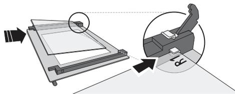
4. Instale novamente a extremidade superior: irá ouvir um clique, indicando que está bem posicionado. Certifique-se de que a vedação está segura antes de montar novamente a porta.
