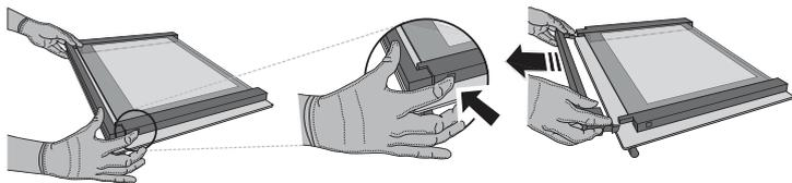
2. Levante e segure firmemente o vidro interior com ambas as mãos, removendo-o e colocando-o sobre uma superfície suave antes de proceder à sua limpeza.
