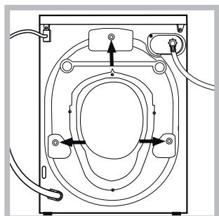
3. Verwijder de **3** schroeven die het apparaat beschermen tijdens het vervoer en de rubberen ring met bijbehorende afstandsleider die zich aan de achterkant bevinden (zie afbeelding).
