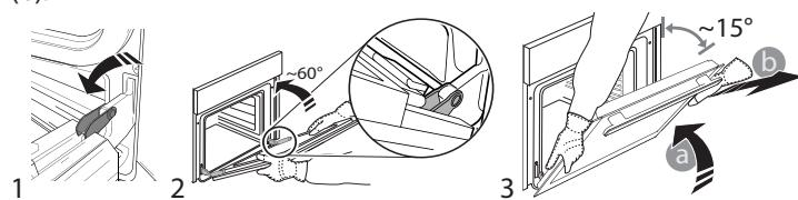
Coloque a porta de parte, apoiando-a sobre uma superfície
