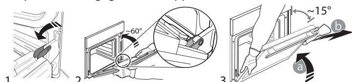
Placez la porte de côté, l'appuyant sur une surface souple. Réinstallez la porte en la plaçant devant le four pour aligner les
