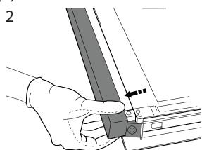
Levante e segure firmemente o vidro interior com ambas as mãos, removendo-o e colocando-o sobre uma superfície suave antes de proceder à sua limpeza (3).
