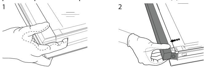
Sollevarne e afferrare saldamente il vetro interno con due mani, rimuoverlo e appoggiarlo su un piano morbido prima di eseguire la pulizia (3).
