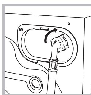
2. Pripojte prítokovú hadicu k práčke, jej zaskrutkováním k príslušnej prípojke na vodu, umiestnenej vpravo hore (viď obrázok).
