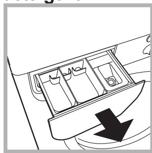
Trageți afara compartimentul ridicându-l și tragându-l spre exterior (*a se vedea figura*). Spălați-l sub un jet de apă; această operație trebuie efectuată cât mai des posibil.
