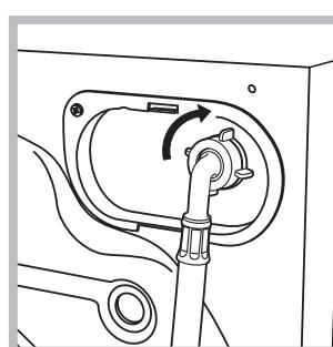
2. A vízbevezető cső csatlakoztatásához csavarozza a csövet a mosógép hátoldalán jobbra fent található vízbemeneti csonkra (lásd ábra)!
