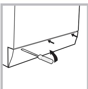
1. scoateți panoul de acoperire din partea din față a mașinii de spălat folosind o surubelnită (*a se vedea figura*);
