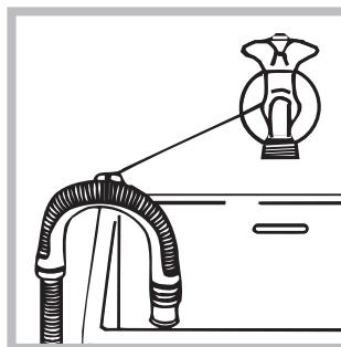
свързвайки доставения водач към крана (вж. фигуранта). Свободният край на маркуча за мръсната вода не трябва да бъде потопен във водата.
