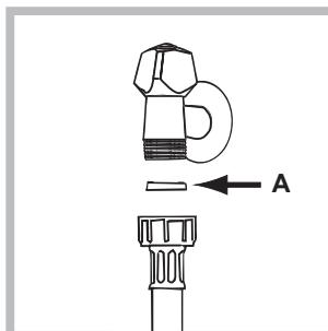
1. Introduceți garnitura A în extremitatea tubului de alimentare și însurubați-l la un robinet de apă rece cu gura filetată de l' gaz (vezi figura).
