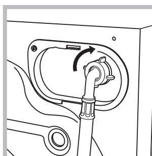
2. Conectați tubul de alimentare la mașina de spălat, însurubându-l la sursa de apă respectivă, amplasată în partea posterioară, sus în dreapta (a se vedea figura).
