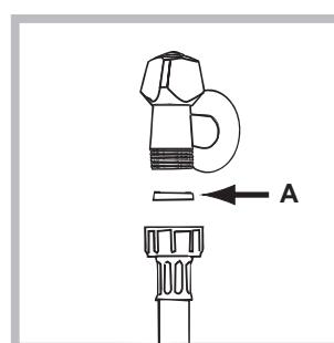
1. Vložte těsnění A do koncové části přítokové hadice a připevněte ji k uzávěru studené vody se závitem 3/4" (viz obrázek). Před připojením hadice nechte vodu odtéci, dokud nebude průzračná.
