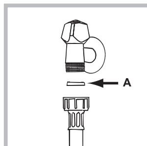
1. Vložte tesnenie A do koncovej časti prítokovej hadice a pripojením ju k uzáveru studenej vody so závitom 3/4" (viď obrázok). Pred pripojením hadice nechajte vodu odtieť, až kým nebudete priezračná.
