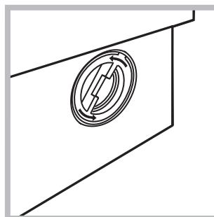
2. Odšroubujte víko jeho otáčením proti směru hodinových ručiček (viz obrázek): výtečení malého množství vody je zcela běžným jevem;
