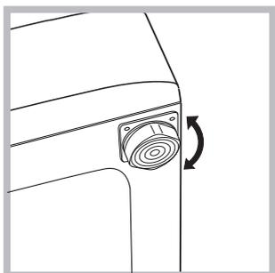
2. Als de vloer niet volledig horizontaal is kunt u de onregelmatigheid opheffen door de stelvoetjes aan de voorkant losser of vastert te schroeven (zie afbeelding); de inclinatiehoek, gemeten
