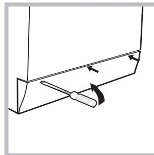
3. démonter le panneau situé à l'avant du lave-linge à l'aide d'un tournevis (voir figure).
