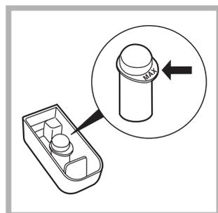
Plaats het bijgeleverde extra bakje 4 in bakje 1. Let er bij het gieten van het bleekwater op dat het niveau "max", aangegeven op de centrale pin, niet wordt overschreden (zie afb.).
