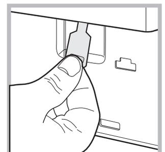
4. trek het lipje dat wordt aangegeven in de afbeelding naar voren totdat het plastic bandje loskomt; trek hem daarna naar beneden en open tegelijkertijd de deur.
