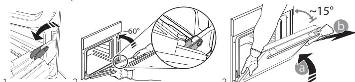
Dvierka odložte nabok na mäkký povrch. Dvierka opäť nasadíte tak, že ich priložíte k rúre, zarovnáte háčiky pántov s dosadacími plochami a upevníte vrchnú časť na sedlo. Dvierka spusťte a potom celkom otvorte. Úchytky sklopte do pôvodnej polohy: dbajte, aby ste ich sklopili úplne. Skúste dvierka zatvoriť a skontrolujte, či sú zarovno s ovládacím panelom. Ak nie, zopakujte predchádzajúce kroky.
