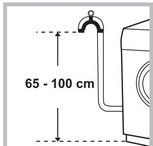
Conectați furtunul de golire - fără a-l îndoia - la canalizare sau la racordul de golire prevăzut pe perete, la o înălțime de 65 - 100 cm de sol.
