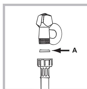
1. Vložte těsnění A do koncové části přítokové hadice a připevněte ji k uzávěru studené vody se závitem 3/4" (viz obrázek). Před připojením hadice nechte vodu odtéci, dokud nebude průzračná.
