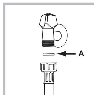
1. Introduceți garnitura A în extremitatea tubului de alimentare și înșurubați-l la un robinet de apă rece cu gura filetată de l' gaz (vezi figura).
