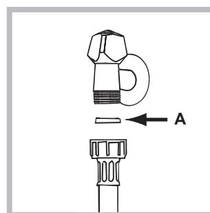
1. Montez le joint A sur l'extrémité du tuyau d'alimentation et vissez-le à un robinet d'eau froide à embout fileté 3/4 gaz (voir figure). Faites couler l'eau jusqu'à ce qu'elle soit limpide et sans impuretés avant de raccorder.
