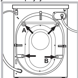
3. Odstraňte 4 šrouby chránící před poškozením během přepravy a gumovou podložku s příslušnou rozpěrkou, které se nacházejí v zadní části (viz obrázek).
