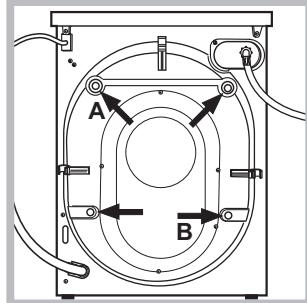
3. Csavarozza ki a gép hátsó részén található, a szállításhoz szükséges 4 védőcsavart, és távolítsa el a gumibabokat (lásd ábra).
