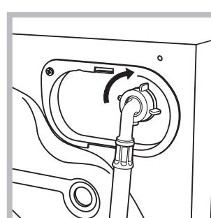
2. Conectați tubul de alimentare la mașina de spălat, înșurubându-l la surse de apă respectivă, amplasată în partea posterioară, sus în dreapta (a se vedea figura).
