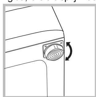
2. Dacă podul nu este perfect orizontal, compensați neegalitățile deșurubând sau înșurubând piciorușele anterioare (a se vedea figura); unghiul de înclinare, măsurat pe planul de lucru, nu trebuie să depășească 2°.
