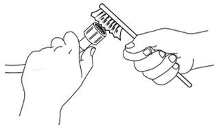
3. Ahora desenrosque a mano la manguera de entrada de la parte trasera de la lavadora. Extraiga el filtro de la válvula que está en la parte trasera de la lavadora utilizando una pinza y límpielo bien.
