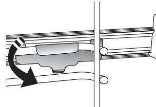
Varmista ohjain paikalleen painamalla pidikkeen alaosaa tiukasti hyllykköohjainta vasten. Varmista, että liukukappaleet liikkuvat vapaasti. Toista nämä vaiheet toiselle samalla tasolla olevalle kannattimelle.
