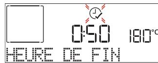
Appuyez sur + ou — pour régler l'heure de fin de cuisson souhaitée, puis appuyez sur ✓ pour confirmer et activer la fonction. Placez les aliments dans le four et fermez la porte : La fonction démarre automatique après une période de temps déterminée pour que la cuisson se termine au moment désiré.
