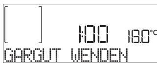
Ein akustisches Signal ertönt und das Display zeigt an, welche Tätigkeit auszuführen ist. Öffnen Sie die Tür, um die über das Display geforderte Tätigkeit auszuführen. Schließen Sie die Tür und drücken Sie dann , um den Garvorgang fortzusetzen.
