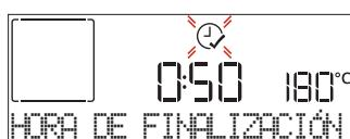
Pulse + o — para ajustar la hora a la que desea que finalice la cocción y, luego, pulse ✓ para confirmar y activar la función. Coloque los alimentos en el horno y cierre la puerta: Esta función se iniciará automáticamente cuando haya transcurrido el periodo de tiempo calculado para que la cocción termine a la hora programada.
