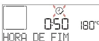
Prima + ou — para definir o tempo de fim da cozedura pretendido e, em seguida, prima para confirmar e ativar a função. Coloque os alimentos no forno e feche a porta: A função inicia-se automaticamente após o período de tempo calculado para concluir a cozedura à hora programada.
