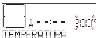
Cuando el valor parpadee en la pantalla, pulse + o — para cambiarlo, después pulse ✓ para confirmar y continuar con los ajustes siguientes (si es posible).
