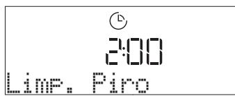
Pulse + o — para seleccionar el ciclo que deseé, luego presione ✓ para confirmar. Una vez que se haya seleccionado un ciclo, si lo desea, pulse + o — para configurar la hora de finalización (inicio retrasado), luego presione ✓ para confirmar.
