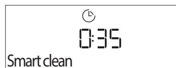
Funkci obnovíte stisknutím ► : Displej vás bude informovat o všech krocích, které je třeba provést, aby bylo dosaženo co nejlepšího výsledku čištění: Řídte se témito pokyny a po jejich dokončení stiskněte ✓ . Po provedení všech kroků spusťte cyklus čištění stisknutím tlačítka ► .
