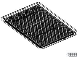
Anvendes til tilberedning af retter med funktionen Luftstegning, med en bradepande anbragt på et lavere niveau til opsamling af eventuelle krummer og dryp. Den kan vaskes i opvaskemaskinen.
