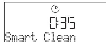
Drücken Sie ▶ zur Aktivierung der Funktion: Das Display fordert Sie auf, alle notwendigen Tätigkeiten auszuführen, um die besten Reinigungsergebnisse zu erzielen: Befolgen Sie die Anweisungen und drücken Sie ✓, sobald diese erledigt sind. Nachdem Sie alle Schritte abgeschlossen haben, drücken Sie ▶, wenn gefordert, um den Reinigungszyklus zu aktivieren.
