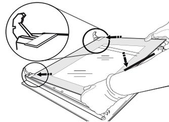
4. Die obere Kante wieder anbringen: Ein Klick bestätigt die richtige Positionierung. Sicherstellen, dass die Dichtung vor Wiedereinbau der Tür befestigt wird.
