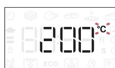
Wenn das Symbol °C auf dem Display blinkt, den Knopf drehen, um den Wert zu ändern, anschließend zur Bestätigung drücken und fortfahren, um die nachfolgenden Einstellungen zu ändern (falls möglich).
