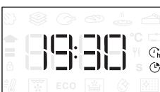
Upozornění: Naprogramování času spuštění odloženého pečení deaktivuje fázi předehřívání trouby: Trouba dosahuje požadované výše teploty postupně, což znamená, že doby přípravy mohou být o něco delší, než je uvedeno v tabulce pro tepelnou úpravu.
