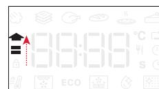
Når denne fase er afsluttet, lyder der et hørbart signal, og displayet angiver, at ovnen har nået den indstillede temperatur.
