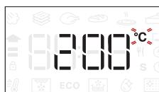
Když ikona °C bliká na displeji, otočte knoflíkem pro změnu hodnoty a poté pro potvrzení stiskněte a pokračujte v přizpůsobování nastavení, které následuje (je-li to možné).
