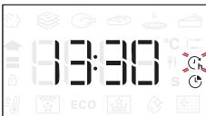
V případě potřeby otáčejte knoflíkem a nastavte požadovaný čas ukončení přípravy. Poté, pro potvrzení volby a spuštění funkce, stiskněte . Vložte pokrm do trouby a zavřete dvířka: Funkce se spustí automaticky po určité době, která byla vypočtena tak, aby příprava pokrmu byla dokončena ve vám nastaveném čase.
