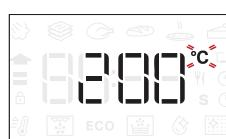
Drej på knappen, når ikonet °C blinker på displayet, for at ændre værdien og tryk herefter på , for at bekræfte og (om muligt) fortsætte med at ændre de efterfølgende indstillinger.
